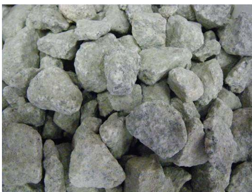
写真-17 散水実施前の骨材外観
