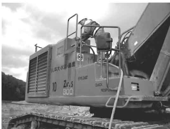
写真-6 バックホウ給油口の手すり
