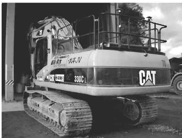
写真-7 バックホウ背面の手すり
