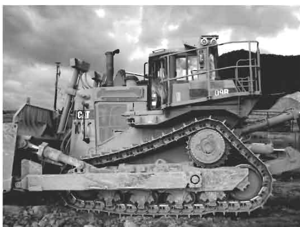
写真-5 ブルドーザの昇降用手すりと 運転席周りの手すり
