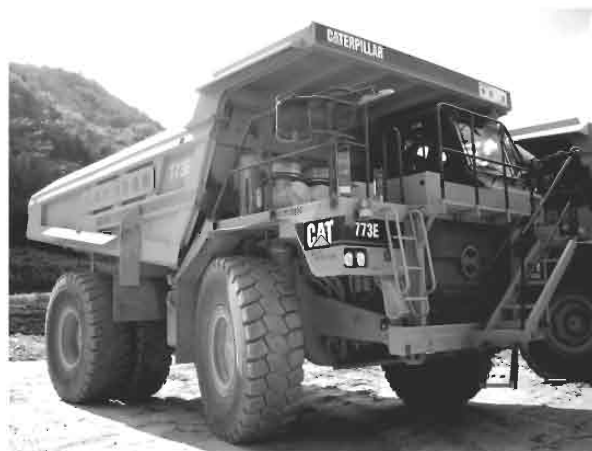
写真-4 重ダンプトラックの昇降設備と運転席周りの手すり
