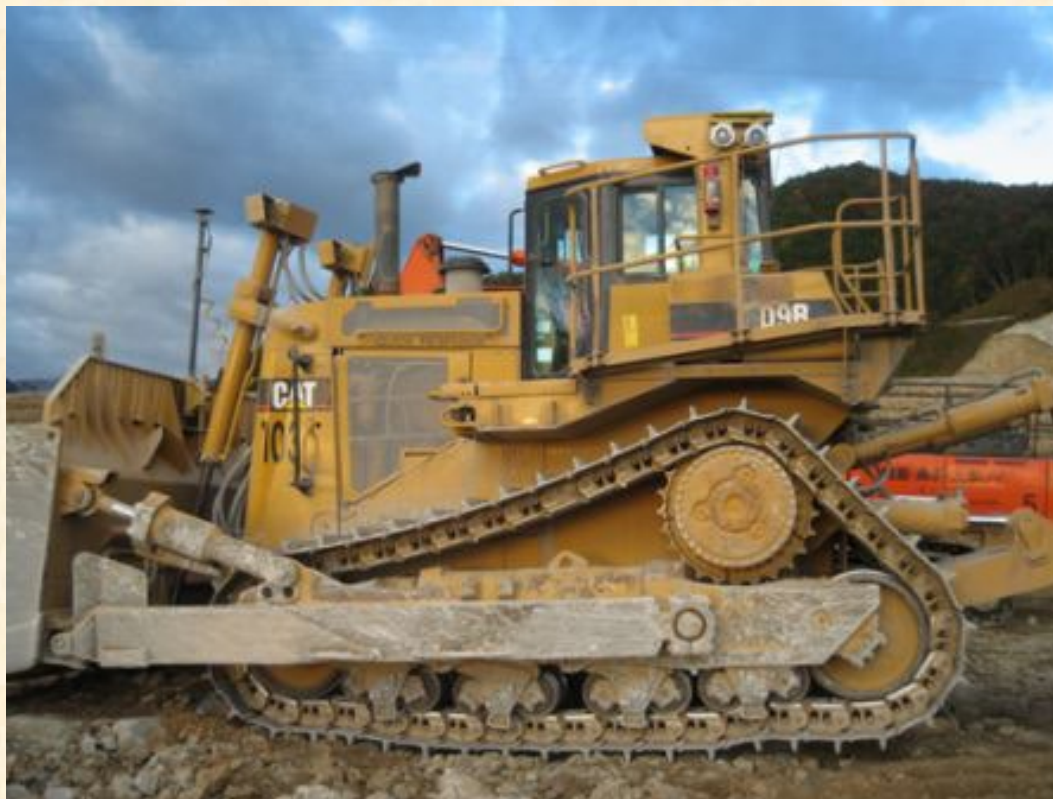
ブルドーザの昇降用手すりと 運転席周りの手すり
