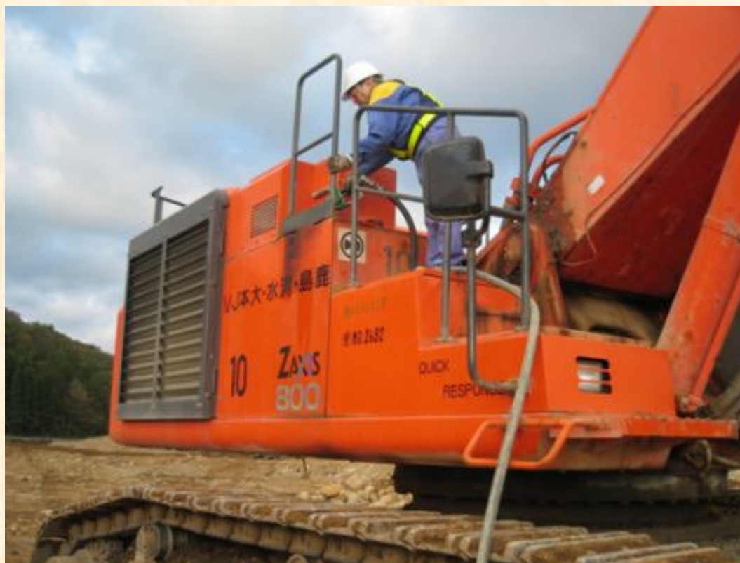
バックホウ給油口の手すり
