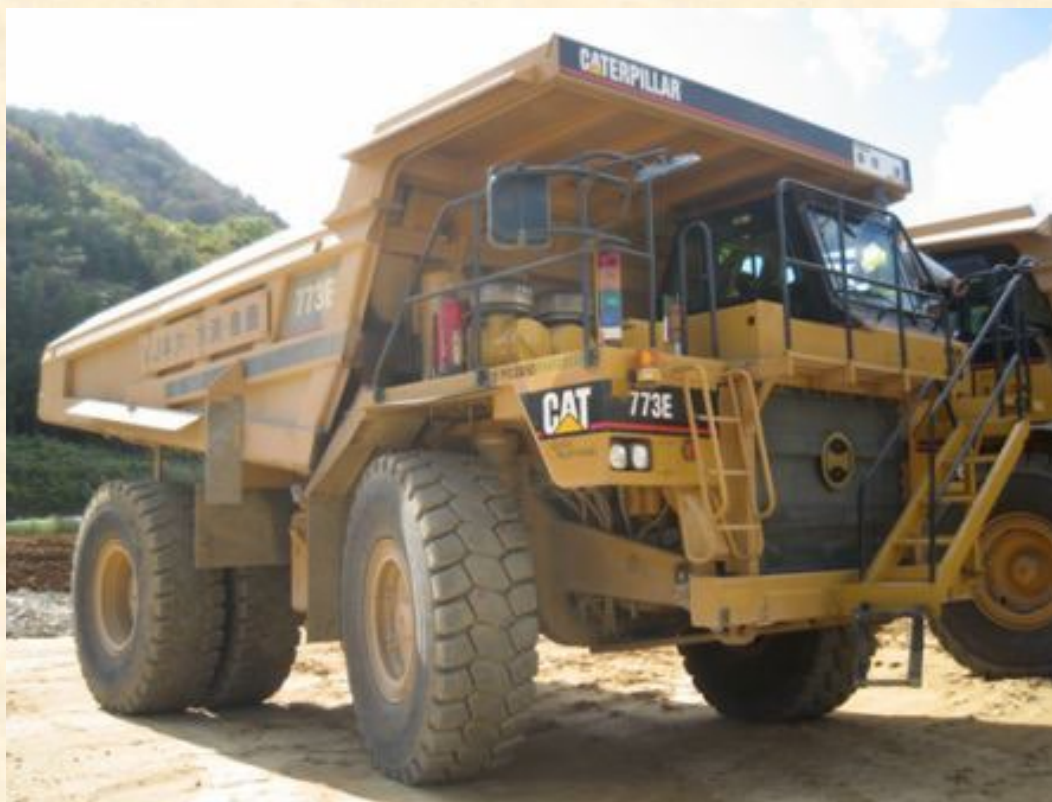
重ダンプトラックの昇降設備と 運転席周りの手すり
